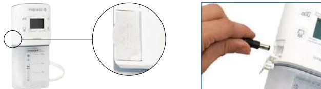
Brancher l'alimentation du dispositif médical Invia Motion sur une prise murale et ouvrir le petit couvercle de protection de la pompe pour accéder à la prise de courant continu (CC), puis brancher l'alimentation. Les barres figurant sur l'écran de la batterie bougent pour indiquer que l'appareil est en charge. [
