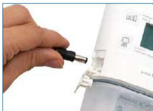
Brancher l'alimentation du dispositif médical Invia Motion sur une prise murale et ouvrir le petit couvercle de protection pour accéder à la prise électrique. Raccorder la prise d'alimentation coaxiale à la prise électrique. Les barres sur l'écran de la batterie bougent pour indiquer que la batterie est en charge [
