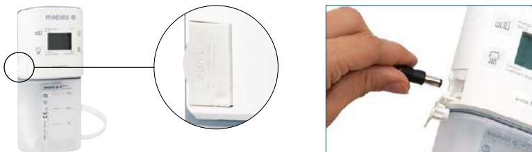
Conecte la fuente de alimentación Invia Motion a una toma de corriente de pared y abra la pequeña tapa protectora para acceder a la toma de CC. Enchufe la fuente de alimentación coaxial a la toma de CC. Las barras intermitentes mostradas en el monitor de la batería indicarán que esta se está cargando [
